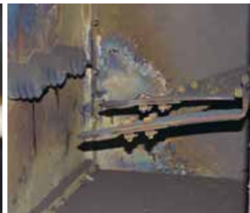
Испытание на дуговой разряд током до 66 кА
