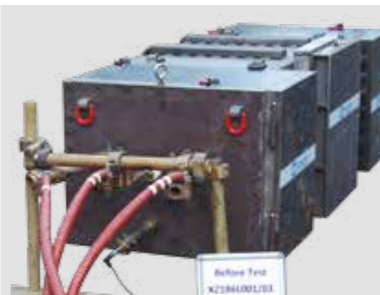
Zabudowa do testów z łukiem elektrycznym do 66 kA
